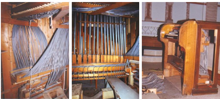
Einblicke in das Innenleben einer pneumatischen Orgel
